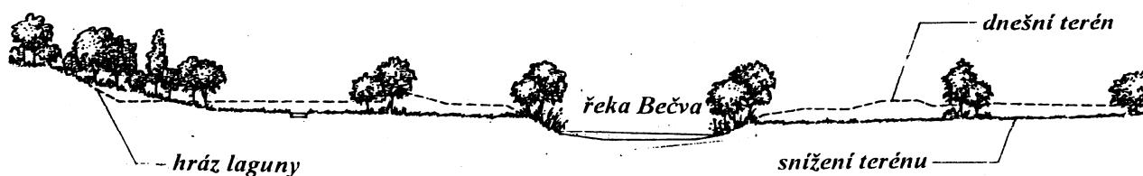
Obr. 4 Bečva – otevření průtočného profilu pod Přerovem
