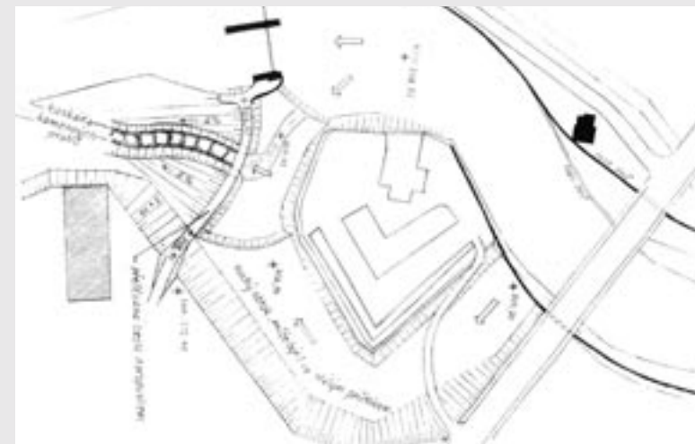
Obr. 3) Návrh na řešení obtoku kolem pevnůstky, která by zůstala stát na ostrově, při jezu na řece Moravě v Olomouci (Nových Sadech), zpracoval Ing. Václav Čermák v roce 2002. Součástí řešení je rybí cesta přes kaskádu kamenných prahů.
