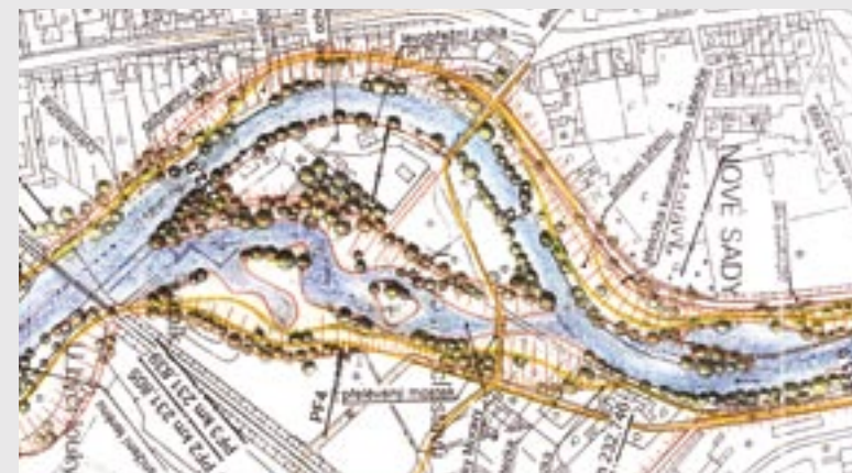
Obr. 1) Návrhová situace zkapacitnění a revitalizace řeky Moravy v oblasti Nových Sadů v Olomouci dle Ing. Čermáka z roku 2001.
