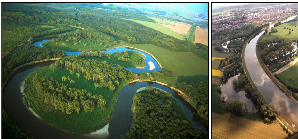
Foto: Řeka Morava meandrující v přirozené trase v oblasti PP Osypané břehy (vlevo) a Morava v regulovaném korytě u Veselí nad Moravou (vpravo).
