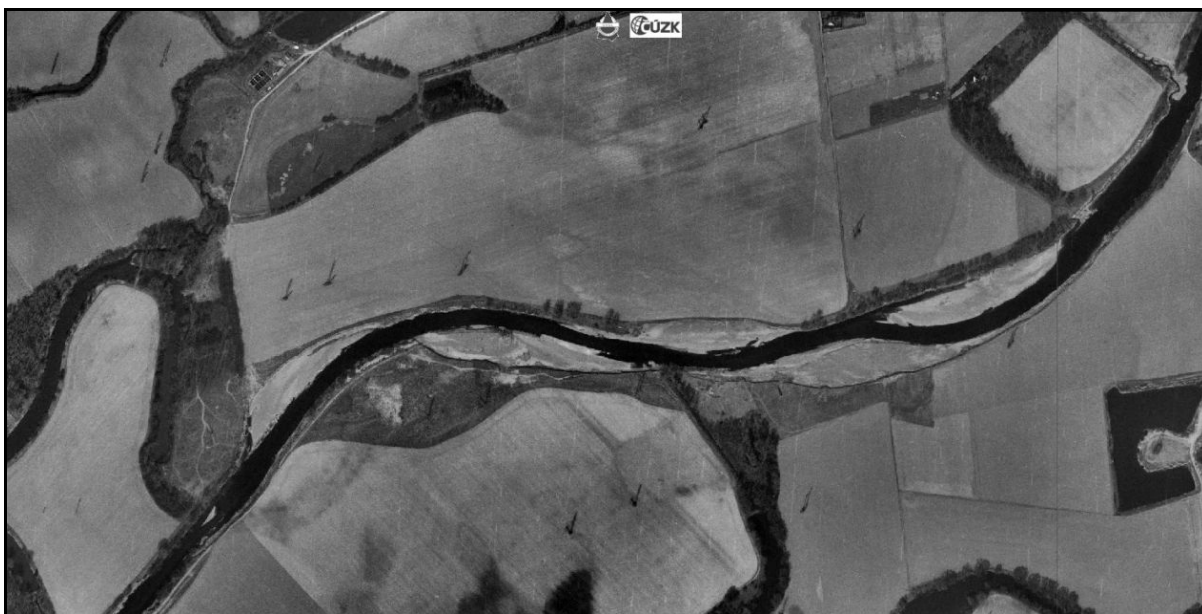
Obr. 2) Osecká Bečva – letecký snímek zachycuje zájmový úsek toku v letech 1998 – 2001. Na snímku jsou výrazně zřetelné nivní stupně, které vznikly během povodně 07/1997. Je jich pět, přičemž horní a dolní stupeň (oba při pravém břehu) mají pozvolný přechod od kynety nahoru, naopak tři stupně ve střední části lokality se vyznačují ostrým přechodem s kolmou výsepní stěnou
