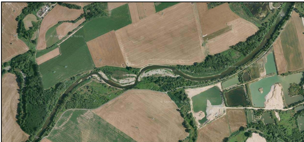
Obr. 7) Osecká Bečva – letecký snímek zachycuje zájmový úsek toku z 4. 7. 2018. Zvyšují se poloměry oblouků výsepních břehů ve střední části lokality. Levobřežní eroze dorazila až k cyklostezce a zcela zde zmizel třetí nivní stupeň (ze střední části zájmového úseku). Břehové opevnění na pravé straně ostré zatáčky stále odolává
