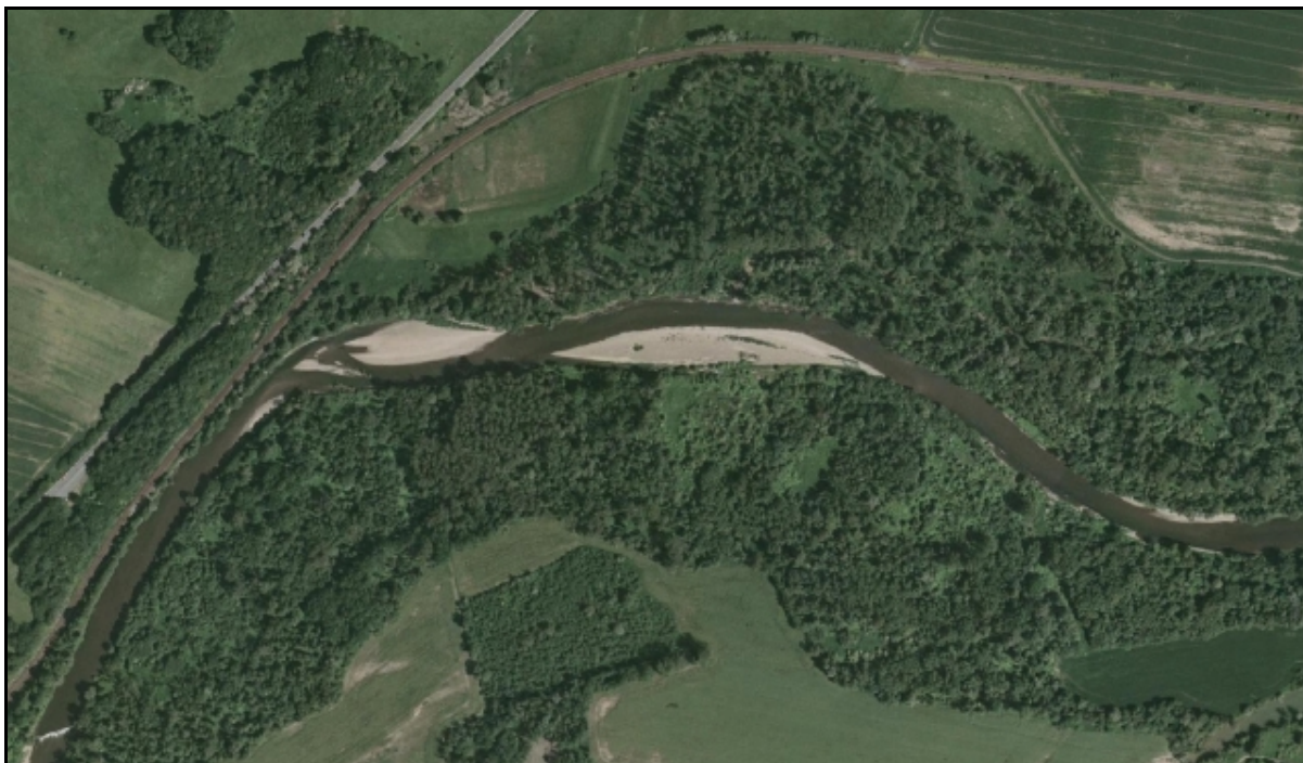
Obr. 18) Bečva pod Miloticemi na leteckém snímku z roku 2006. Zachycuje stav po jarní povodni z téhož roku, která zcela erodovala dolní levobřežní náplav. Na jeho místě vznikla říční kyneta a výsepní břeh. Nový a rozsáhlý dolní náplav vznikl při pravém břehu řeky
