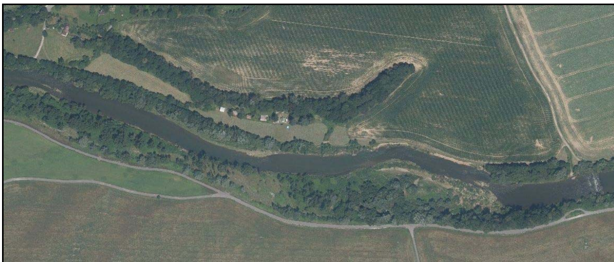
Obr. 14) Bečva u Familie – letecký snímek z jara 2020 s horní částí zájmového úseku toku (tzv. Zadní Familie). Je vidět, že povodeň z června 2019 částečně obnažila neopevněný úsek výsepního břehu. V současnosti (06/2021) je tento úsek zcela zbaven vegetace a došlo zde k laterální erozi v řádu jednotek metrů (vliv povodně z 10/2020). Dílčí výtrž nad kratším výhonem se propaguje, došlo k částečnému obnažení základů tohoto objektu
