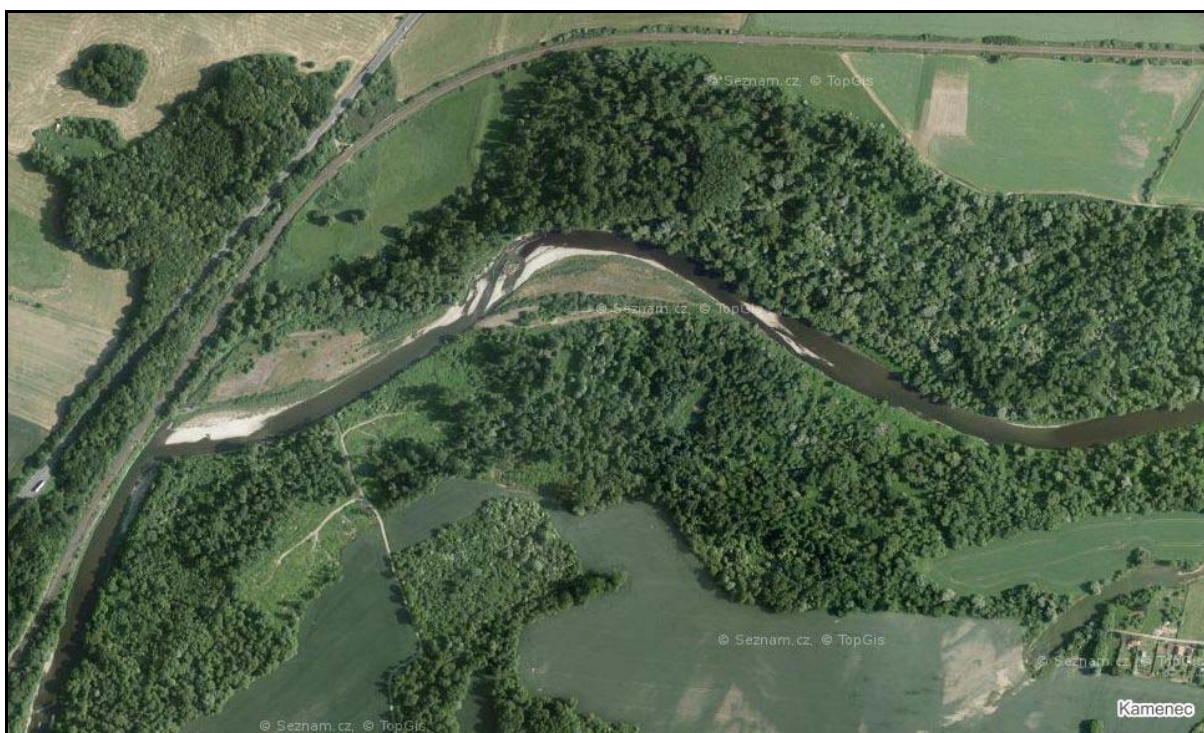
Obr. 21) Bečva pod Miloticemi na leteckém snímku z 13. 6. 2015. Oproti předchozímu snímku došlo k začlenění pravobřežní břehové výtrže do širšího oblouku výsepního břehu a na jejím místě se vytvořily štěrkové lavice a jesepty s větvičí se kynetou, sedimentací a členité utváření koryta v tomto místě zásadně ovlivňovaly stále přítomné akumulace říčního dřeva
