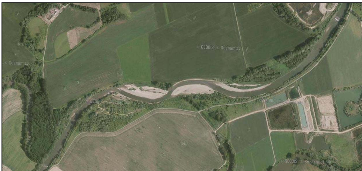
Obr. 5) Osecká Bečva – letecký snímek zachycuje zájmový úsek toku v r. 2012. Ve středním úseku jsou horní dva nivní stupně již zcela oderodovány a probíhá eroze třetího nivního stupně (na protější straně vzniká rozsáhlý štěrkový náplav). Zcela horní a dolní nivní (tedy ty na okrajích zájmového úseku) stupeň zarostl vegetací. Výsepní oblouk – „Břehulí břeh“ – se dostal výrazně mimo rámec širokého povodňového koryta, jež vzniklo v 07/1997. Na uvedené změny měla vliv zejména povodeň v 05/2010
