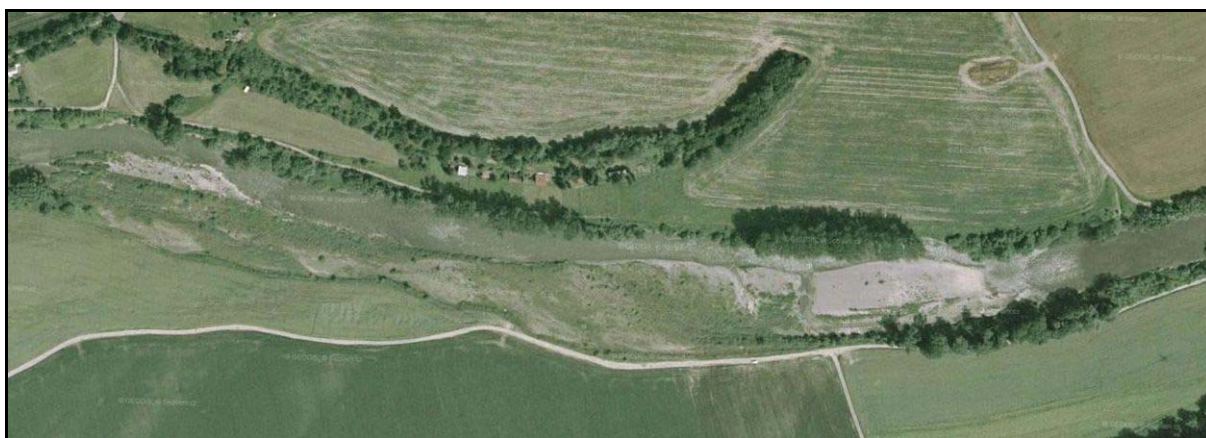
Obr. 9) Bečva u Familie – letecký snímek z let 2001 - 2003 s horní částí zájmového úseku toku (tzv. Zadní Familie). Zřetelně odlišný je rozsáhlý štěrkový náplav v horní části úseku, který je bez vegetace a častěji přeplavovaný, než níže navazující nivní stupeň. Navíc byl tento štěrkový náplav takřka trvale obtékán menším říčním ramenem, takže vytvářel ostrov
