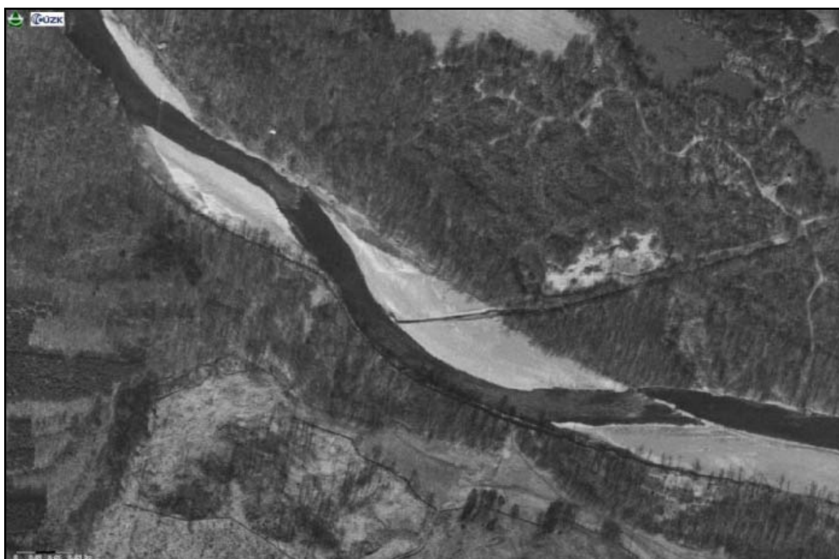
Obr. 25) Bečva pod Choryní na leteckém snímku z roku 1999. Záběr znázorňuje část zpřírodněného úseku, který vytvořila povodeň z 07/1997 (není vidět horní díl lokality). Povodeň strhla hlinité náplavy a obnažila štěrkové vrstvy. Vznikly zde tři nivní stupně, které byly zpočátku bez vegetace, ale v dalším období sukcesně zarůstaly bylinnou a dřevinnou vegetací. Nejnižší části nivních stupňů přechází v často přeplovované štěrkové náplavy, které zůstávají bez rostlinného pokryvu
