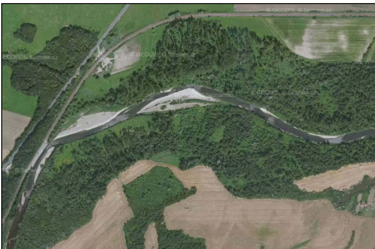
Obr. 19) Bečva pod Miloticemi na leteckém snímku z roku 2009. Zaznamenává situaci před povodní z 05/2010, při které došlo k velké pravobřežní výtrži a vytvoření rozsáhlé akumulace říčního dřeva v prostoru mezi oběma štěrkovými náplavy. Již před povodní 2010 docházelo k poměrně rychlé erozi pravého břehu naproti horního náplavu
