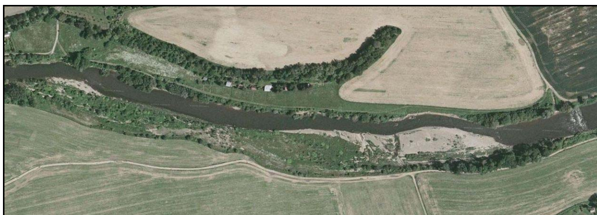
Obr. 10) Bečva u Familie – letecký snímek z roku 2006 s horní částí zájmového úseku toku (tzv. Zadní Familie). Je vidět pravobřežní výtrž o délce cca 100 m, která se nachází přesně v místě břehového porostu, jež byl tvořen vzrostlými hybridními topoly. Došlo též k vybudování balvanitého skluzu, jež vymezuje horní konec zájmového úseku
