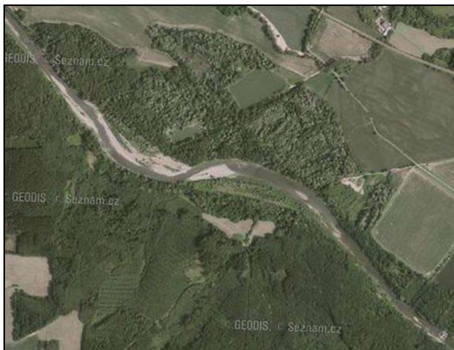
Obr. 29) Bečva pod Choryní na leteckém snímku z roku 2010, oproti předchozímu roku došlo k půdorysným změnám štěrkových náplavů na dolním konci úseku
